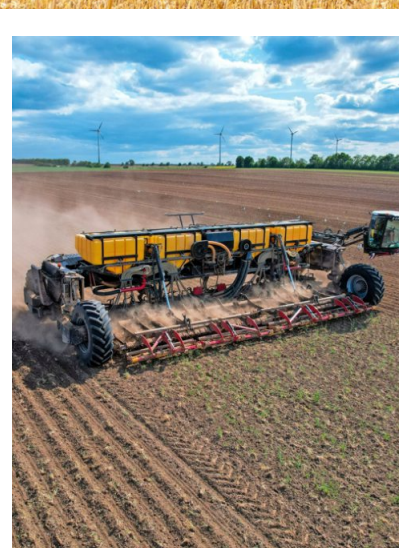
14 Meter Radstand: Der Nexat wird wahlweise mit Raupenantrieb (oben) oder Rädern ausgestattet. Das Fahrzeug trägt unterschiedliche Maschinen.
