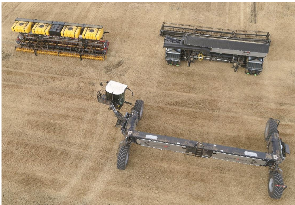
Abbildung 29: Modulwechsel des NEXAT-Systems
